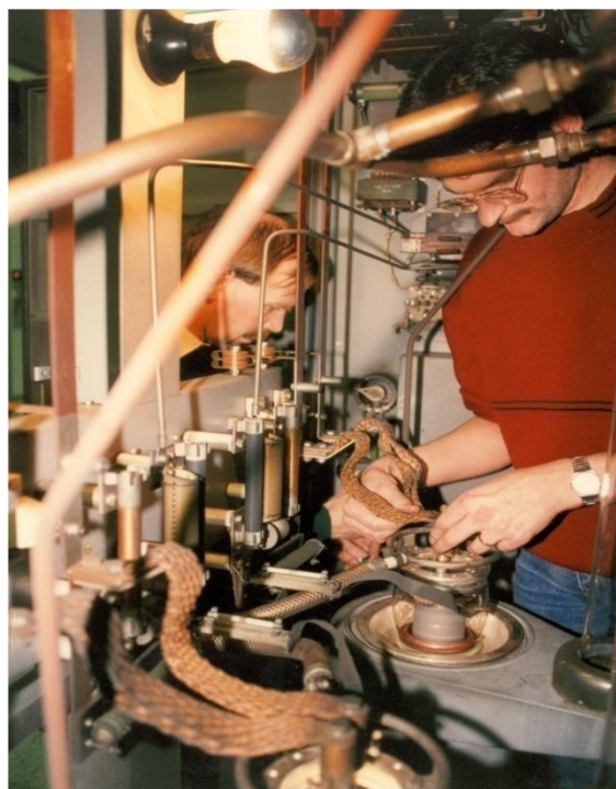
Vervangen van een eindbuis in de zender
