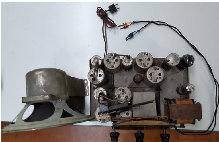
Het bovenaanzicht. De gekleurde banaanstekkers zijn de aansluitingen van de luidspreker. Twee voor de luidsprekerspoel en twee voor de spoel van de elektromagneet.
