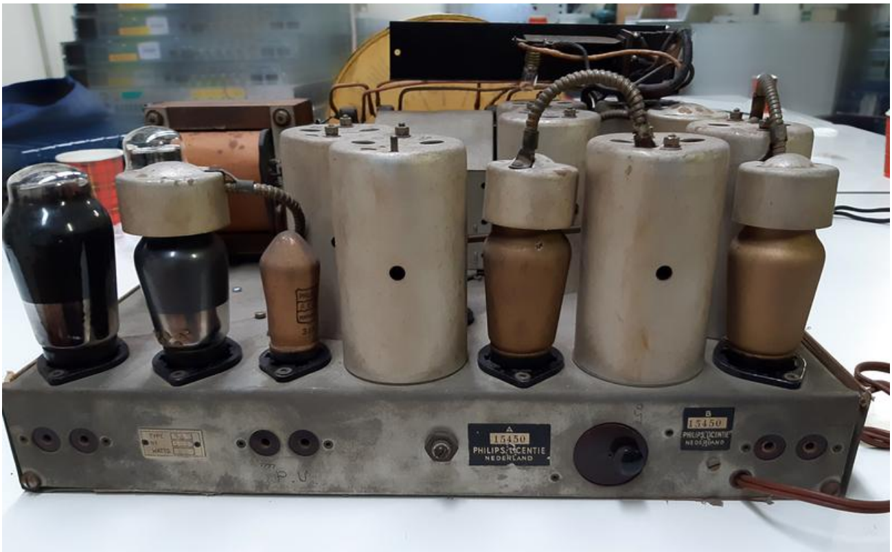
Het chassis met 8 "radiolampen"
