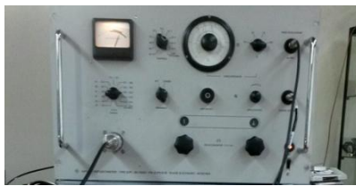
Impulsreflectometer type ZUPI van Rohde & Schwarz
