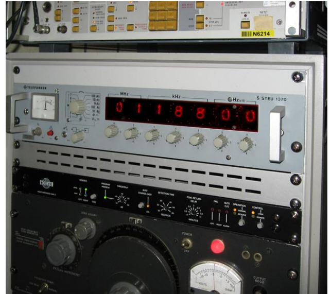
De Telefunken synthesizer geeft de ingestelde frequentie aan met Nixie buizen.
